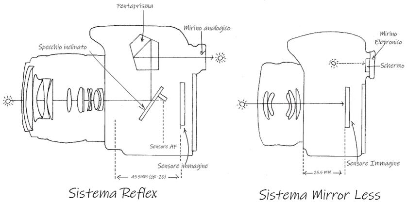
Fig. 2.6 – Differenza tra sistema reflex e sistema mirrorless.
