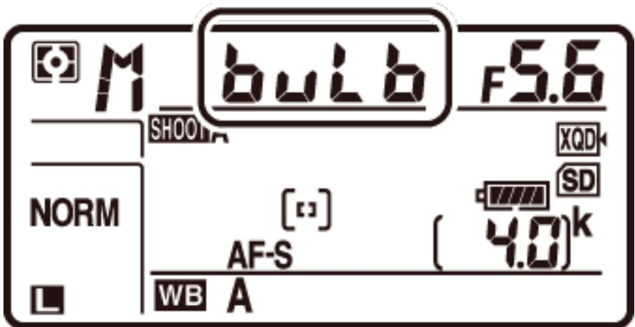
Fig. 2.3 – Posa B (Bulb) visualizzata sul display della fotocamera.
