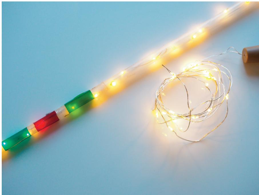
Fig. 4.30d – tubetto opalino con stringa di rame e micro LED, e aggiunta di gelatine colorate.
