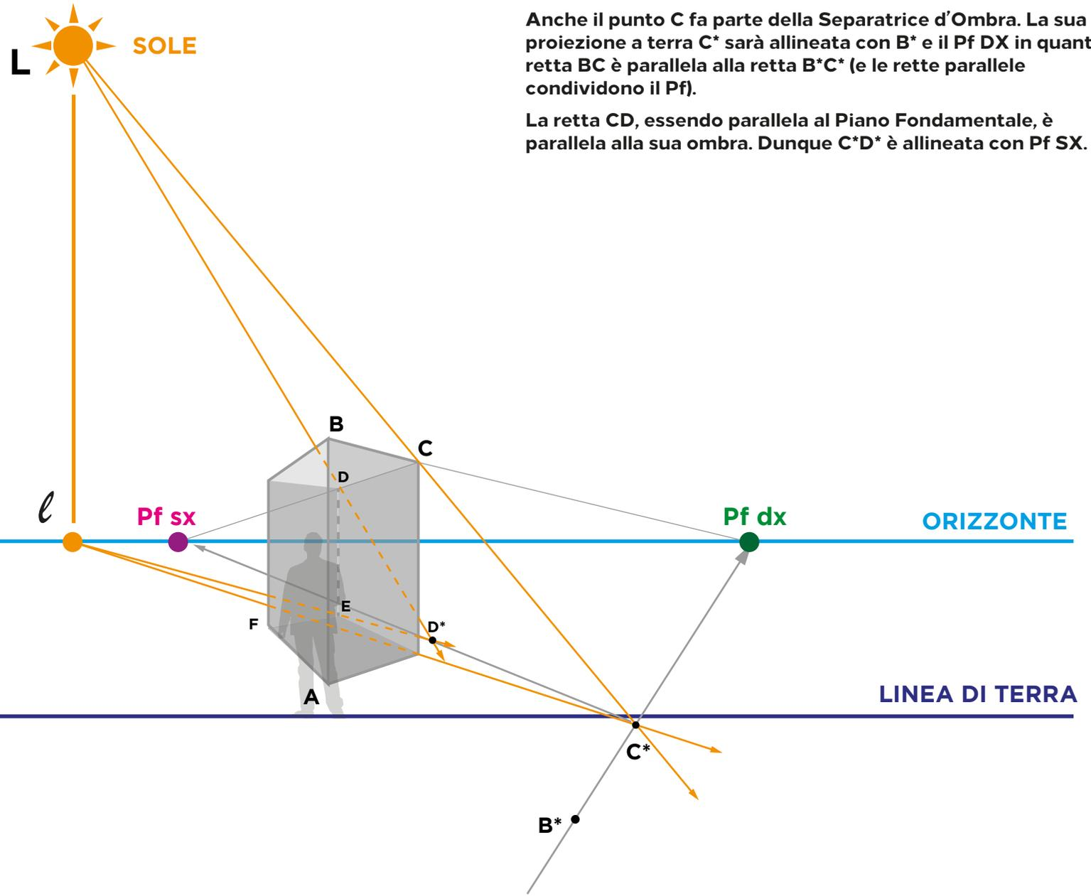
Anche il punto C fa parte della Separatrice d'Ombra. La sua proiezione a terra  $C^*$  sarà allineata con  $B^*$  e il Pf DX in quanto la retta BC è parallela alla retta  $B^*C^*$  (e le rette parallele condividono il Pf).
