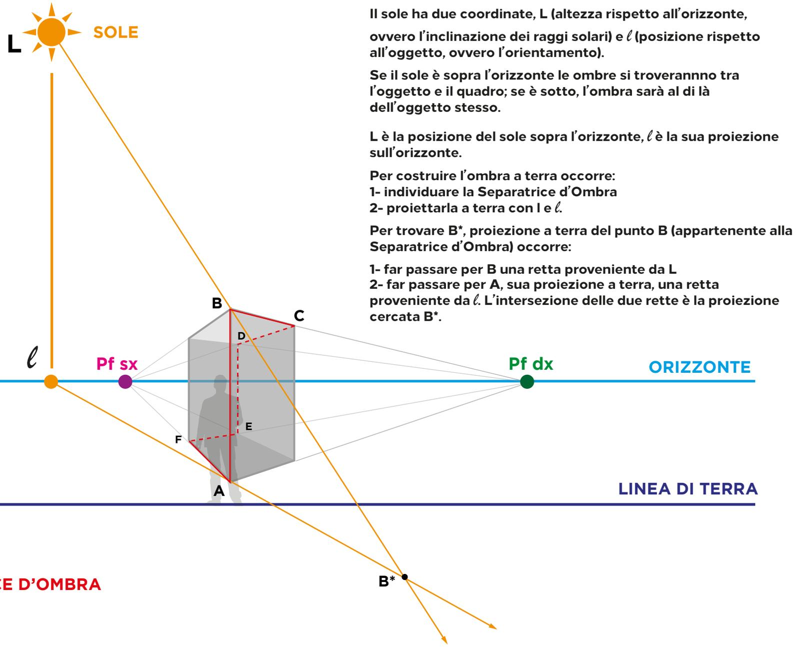
Il sole ha due coordinate,  $L$  (altezza rispetto all'orizzonte, ovvero l'inclinazione dei raggi solari) e  $l$  (posizione rispetto all'oggetto, ovvero l'orientamento).
