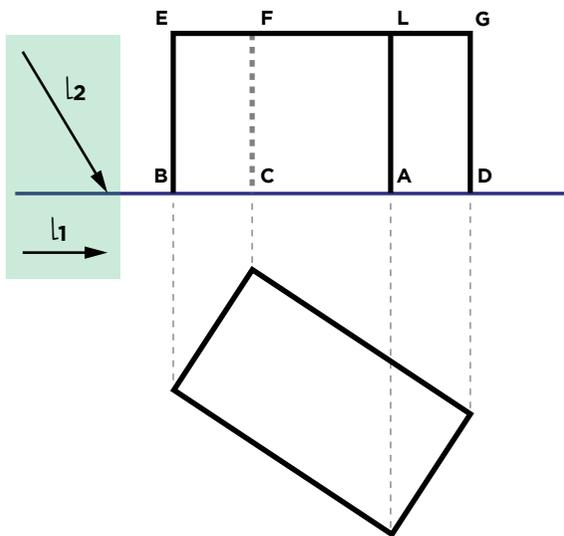
Si può iniziare da qualunque vertice del solido e si procede domandandosi quale sia il tratto di Separatrice. Ad esempio partendo da A, il segmento che separa una faccia in luce da una in ombra è AL; dunque si continua da L verso G e così via.
